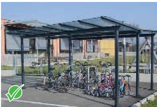
Abb. 30: Überdachte und nah am Eingang positionierte Abstellanlage: Überdachung (Modell K, Fa. Innovametal), Radständer (Modell Kappa, Fa. Innovametal), Foto: Innovametal.
