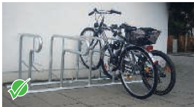
Abb. 1: Mobiler Radständer, alle Bügel gleiche Höhe, hohe Qualität (Modell Zeta, Fa. Innovametall bzw. Modell Valero, Fa. Rasti), Foto: H. Hammerschmidt.
